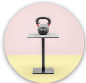
DIN EN 15372 100 kg Belastung / 100 kg load / Charge de 100 kg
